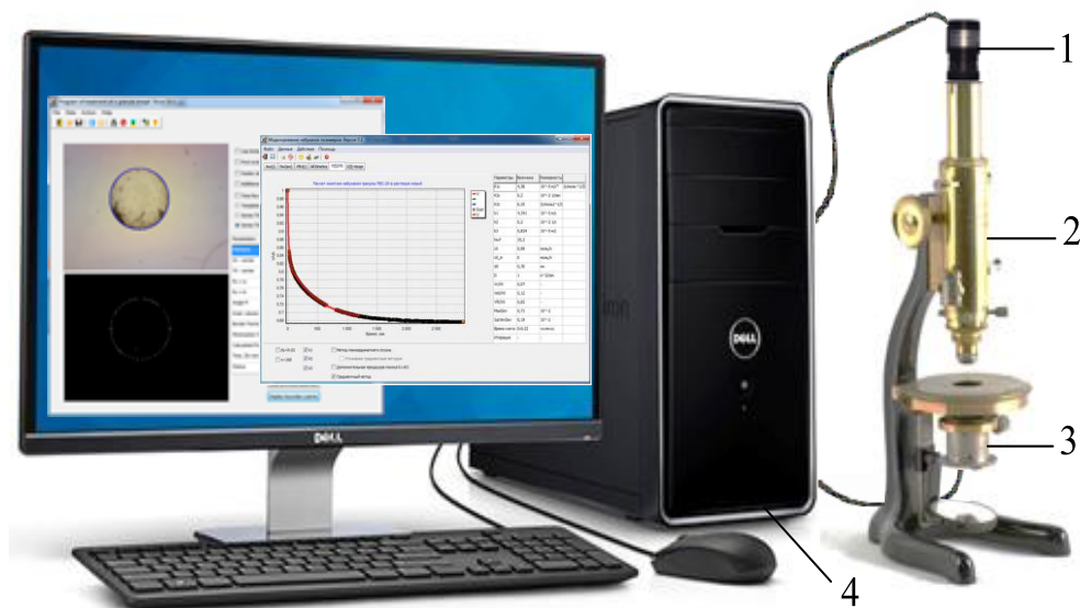
Рис.1. Прибор для изучения набухания композита поливиниловый спирт-магнетит методом оптической микрометрии. 1-видеокамера в светозащитном футляре, 2-оптический микроскоп, 3-источник света, 4-ПК, снабженный необходимым пакетом программ.
